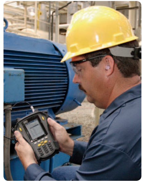
Registro de los valores de vibración usando un sistema de captura de datos de la serie SKF Microlog
