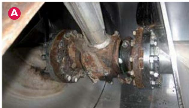
La imagen A muestra un rodillo liso o buje en un conductor por sinfín en una fábrica de azúcar francesa. La corta vida útil además del desgaste del eje y la contaminación del producto final por corrosión y aceite suponían problemas importantes.
