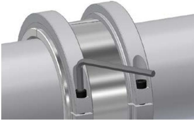
Con un mazo o martillo de plástico o otro material blando, golpea ligeramente cada mitad de la pista interior y los anillos de fijación para colocarlos en el eje. De no tener un mazo de plástico, pueden utilizar un martillo con un taco de madera interpuesto entre el martillo y los componentes del rodamiento. Apretar de nuevo los tornillos de los anillos de fijación. Repetir hasta que los tornillos estén bien apretados.
