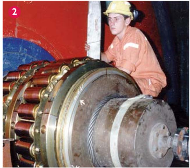
**2.** Un rodamiento doble especial para eje de diámetro 700mm para una bobinadora montada en la torre de una mina de cobre. La carga operacional normal es de 185 toneladas a una velocidad de 54 rpm.
