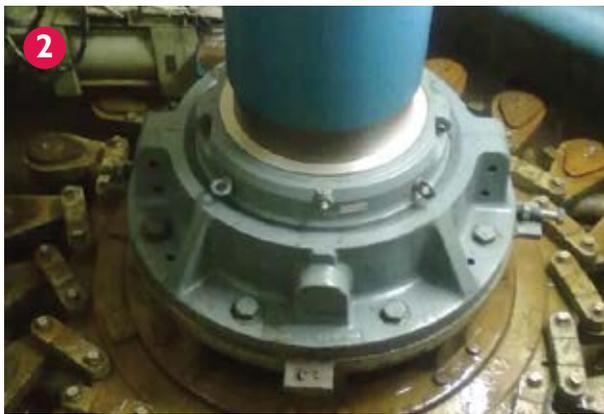
**2.** 01 BCF 380mm en el eje vertical de una turbina hidráulica.
