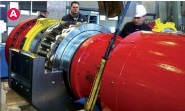
Rodamiento de doble hilera de rodillos cónicos partido de diámetro 780mm en un eje de unión de la industria siderúrgica.
