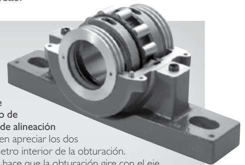
La imagen muestra una obturación de triple laberinto en un conjunto de rodamiento y cartucho de alineación de la serie 01E. Se pueden apreciar los dos anillos tóricos en el diámetro interior de la obturación. La compresión del anillo hace que la obturación gire con el eje, aunque el nivel de compresión es diseñada de forma que el eje se desplace a través de la obturación cuando se produce una expansión axial en los rodamientos EX.
