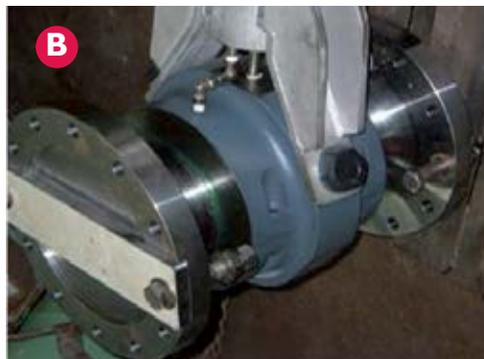
La solución especial de la imagen B muestra un soporte colgante de triple muñón con rodillo partido y obturación doble y purga por aire en cada extremo.
