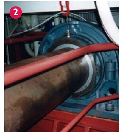
**2.** Una típica instalación de un conjunto Cooper BCP (rodamiento, cartucho, soporte pedestal) en una línea de ejes de propulsión.
